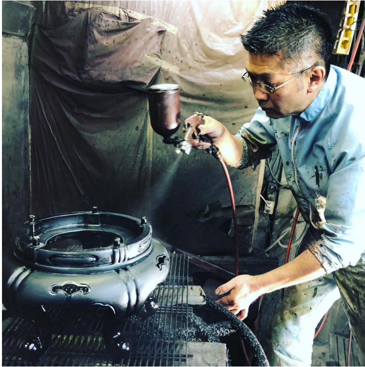
Urushi wird mit Spritzpistole aufgetragen
