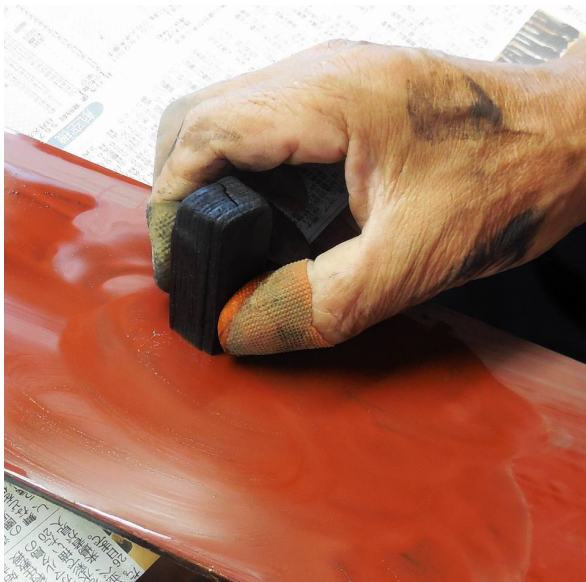
Dôzuri, feinschleifen der Lackoberfläche vor der Politur «Uwaazuri»
