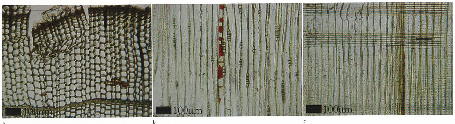
Abb. 11 Kabinettkästchen, Herzog Anton Ulrich-Museum Braunschweig, Inv.-Nr. OA LAC 725, mikroskopische Holzanalyse (exemplarisch), a Querschnitt, b Tangentialschnitt, c Radialschnitt zeigen die charakteristischen Bestimmungsmerkmale von sugi (Japanische Zeder, Cryptomeria japonica ) oder kōyō-zan (Spießtanne, Cunninghamia lanceolata ), mikroskopisch fotografiert unter polarisiertem Durchlicht
